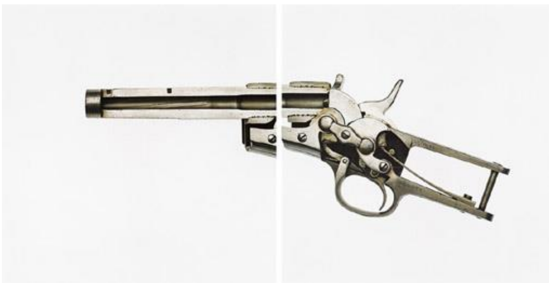
3. Mecanismo del fusil Remington
